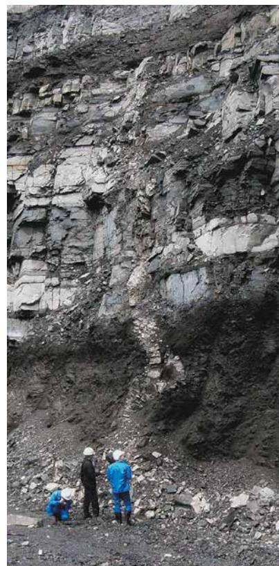
Внедрение даек диабазов в зонах трещиноватости на Красногорском разрезе
